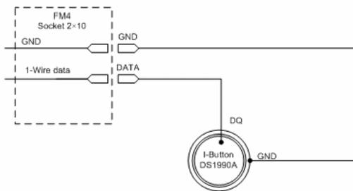
Figure 3. Dallas key iButton DS1990A connection scheme.
